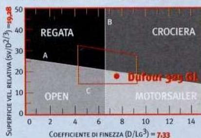
**LEGENDA:** A-B: più uno scafo si allontana da queste due linee e più presenta le caratteristiche di uno dei quattro settori colorati. C: trapezio che contiene il 70% della flotta. **SUPERFICIE VELICA RELATIVA:** valore alto = barca molto invelata in rapporto al suo peso. **COEFFICIENTE DI FINEZZA:** valore basso = barca leggera - valore alto = barca pesante.
