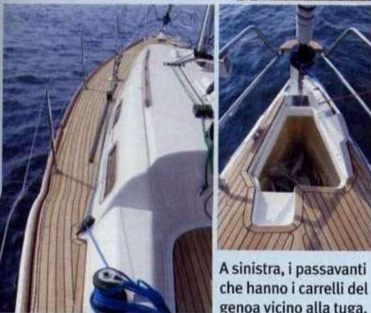
Sopra, il pozzetto corredato di lunghe panche e di una disposizione ergonomica delle manovre. A sinistra, il profondo pozzo per la catena.
